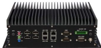
Der lüfterlose Mini-PC mit AMD® Ryzen V1807 CPU. Dank erweitertem Temperaturbereich und wide range Stromeingangs auch als Vehicle-PC geeignet.
